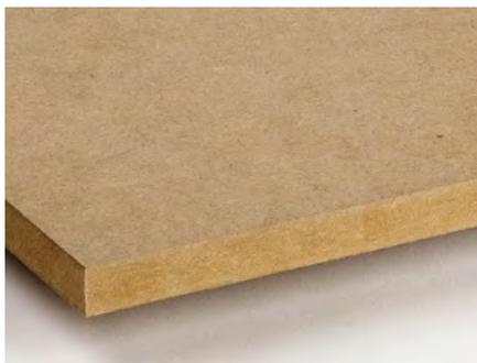
Le MDF (Medium Density Fiberboard) est un panneau de fibres de bois fabriqué à partir de grumes écorcées puis réduites en copeaux. Les fibres sont ensuite encollées et acheminées vers une épandeuse où elles forment un tapis d'une épaisseur de près de 30 fois supérieure au panneau en bout de chaîne de production. Après le pressage, les panneaux sont sciés à la longueur voulue. Il peut être lasuré, peint ou vernis. De plus, il n'y a pas de sens de fibres à observer pour le rabotage ou le ponçage.
