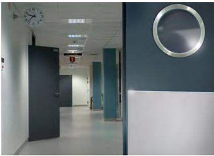
Les blocs-portes à Dispositif Actionné de Sécurité (DAS), conformes à la norme NF S 61-937-2, sont des blocs-portes feu qui, pour des raisons pratiques et sécuritaires, restent en position ouverte en situation normale (pas d'incendie) mais qui devront obligatoirement se refermer en cas d'incendie.
